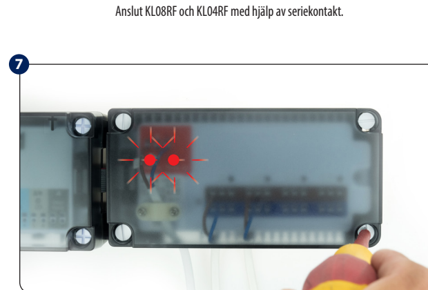
Se till att alla ledningar är ordentligt anslutna, montera toppskyddet och slå upp ledningscentret - "Power" och "Connection" röda LED-dioder lyser och indikerar rätt anslutning till KL08RF-ledningscentret.
